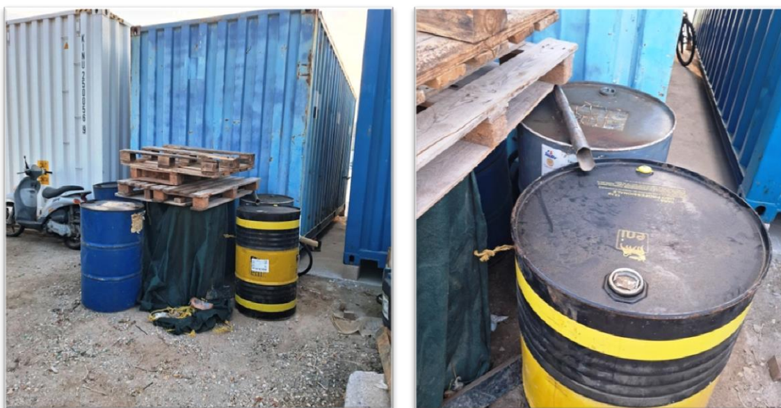
Εικόνα 35: Βαρέλια τύπου UN (200lt) στη λιμενική εγκατάσταση Σκάλα Πάτμου (2024)
